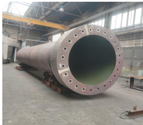
Ocelová část nohy/dříku vodojemu ve výrobní hale
