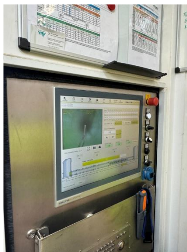
Zařízení vozu pro kamerování potrubí
