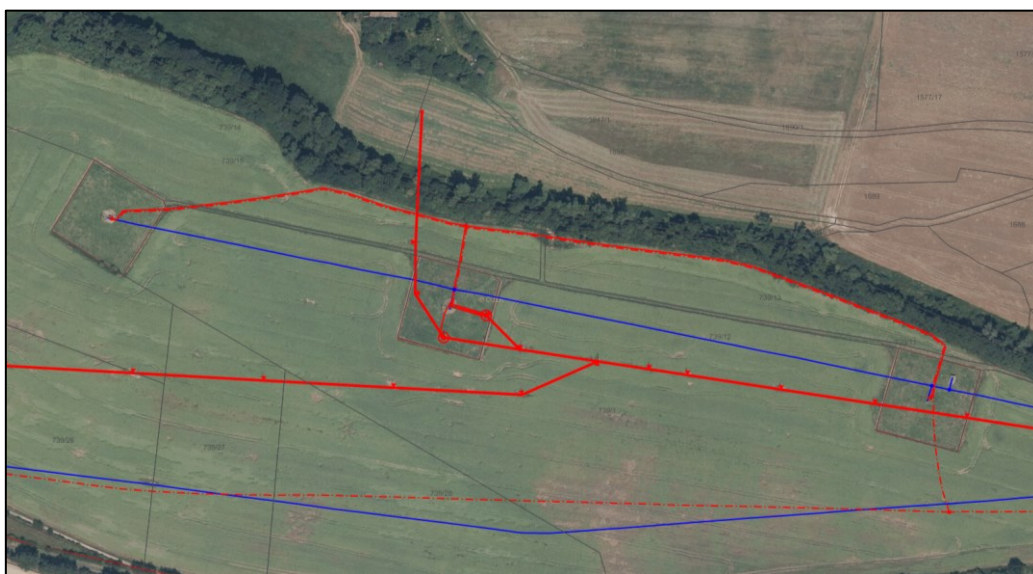
ukázka zakreslených elektrických přípojek pro vrty v Rakovníckém prameništi
